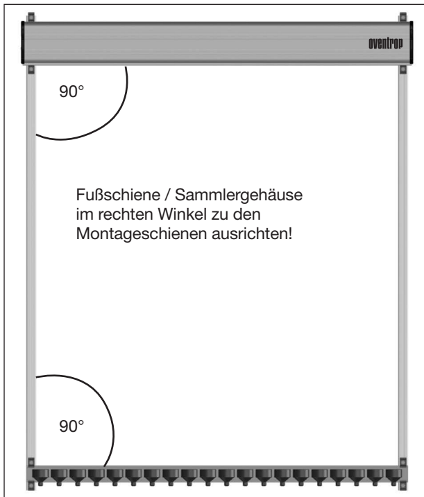
Abb. 17: Röhrenkollektor (Abb. OKP 20) ohne Vakuumröhren
