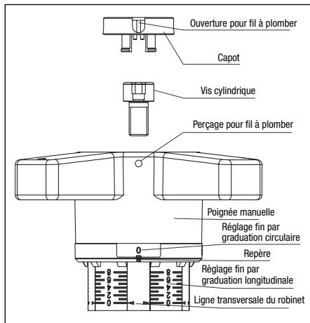
Fig. 5 Poignée manuelle DN 65 à DN 150
