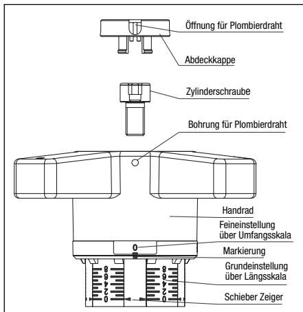
Abb. 5 Handbetätigung DN 65 bis DN 150
