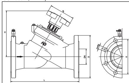
Fig. 2 Encombrements DN 65 à DN 150
