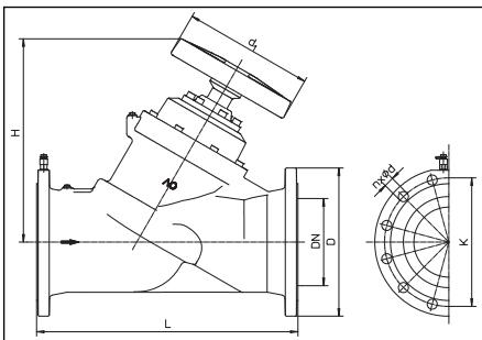
Abb. 3 Abmessungen DN 200 bis DN 300
