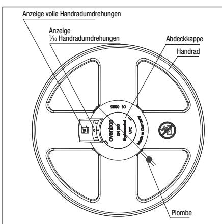
Abb. 7 Handrad blockieren, DN 200 bis DN 300
