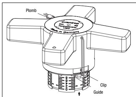
II Fig. 6 Blocage de la poignée manuelle DN 65 à DN 150
