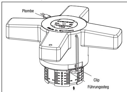
Abb. 6 Handrad blockieren DN 65 bis DN 150
