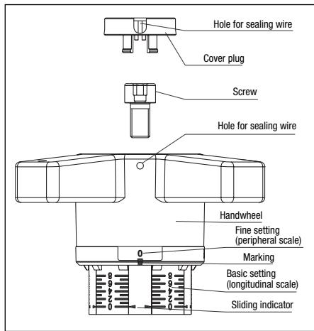
Illustr. 5 Handwheel DN 65 - DN 150
