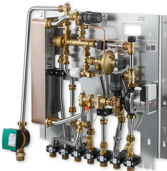
Regudis W-HTF met gemengde verwarmingsgroep, circulatieleiding en extra aansluiting voor een radiatorgroep en tijdgestuurde tapwater circulatieleiding.
