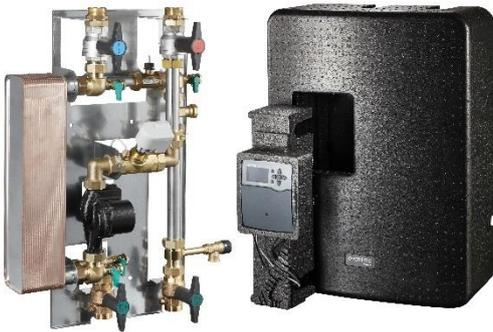
Die Regumaq X-70 Frischwasserstation ist eine elektronisch geregelte Armaturengruppe mit Wärmeübertrager zur hygienischen Trinkwassererwärmung nach dem Durchlaufprinzip zum Anschluss an einen Pufferspeicher. Abhängig von der Temperatur und dem Volumenstrom auf der Trinkwasserseite wird die Umwälzpumpe auf der Heizungsseite drehzahl geregelt. Bei der Auswahl der Frischwasserstation ist es notwendig die Wasserqualität des Einsatzgebietes zu beachten.
