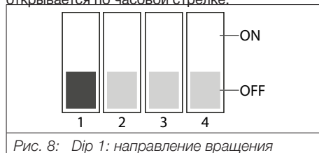
Рис. 8: Dip 1: направление вращения
