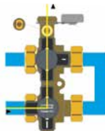
Golirea instalației/ consumatorului, aerisirea și spălarea instalației
