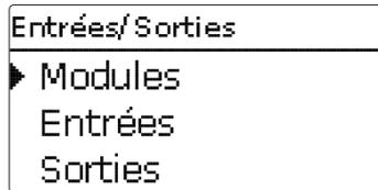
Le menu **Entrées/Sorties** permet d'activer et de désactiver les modules externes, de régler les offsets des sondes et les sorties de relais.
