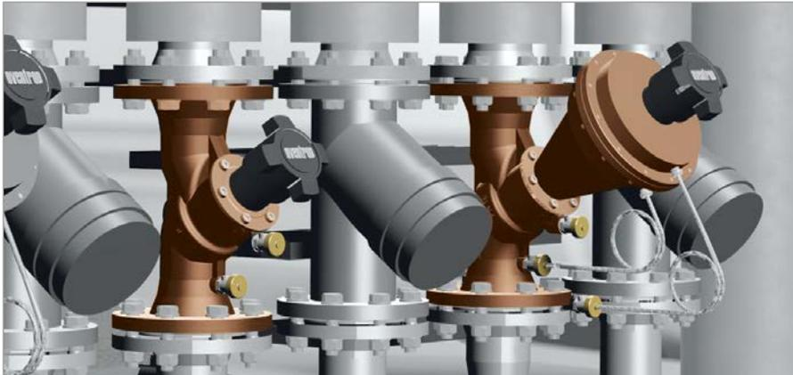
Ausschnitt aus einer Heizzentralen-Planung mit AutoCAD und 3D-Darstellung der Oventrop Ventile
