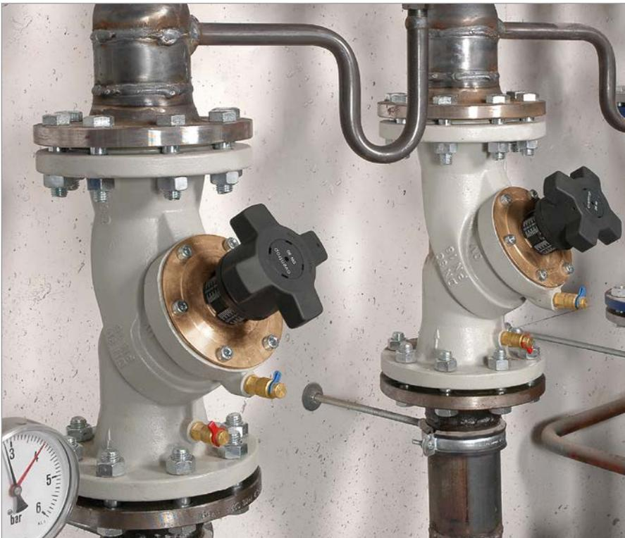
„Hydrocontrol VFC“ Grauguss-Strangregulierventil PN 16, DN 80, in einer Heizwasser-Verteilung zum hydraulischen Abgleich
