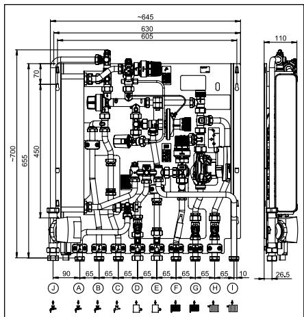
Fig. 4.2 Dimensioni con circuito alte temperature e ricircolo
