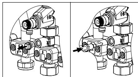
Fig. 6.5 Montaggio tappi
