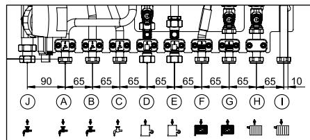
Fig. 4.3 Cotes de raccordement
