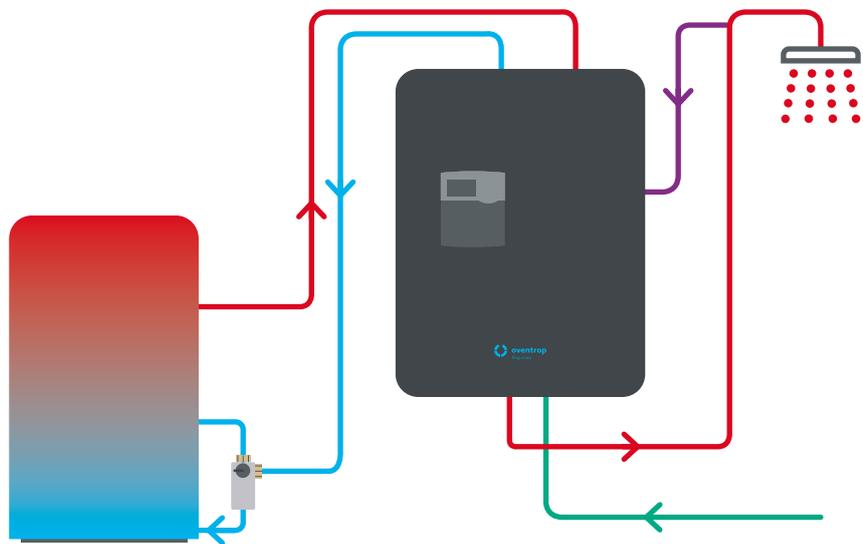
■ Trinkwasser kalt (PWC) ■ Trinkwasser warm (PWH) ■ Trinkwasser warm Zirkulation (PWH-C)
