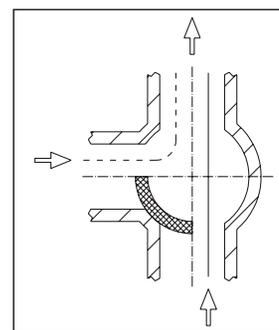
Le mélange est obtenu par la rotation du clapet de la vanne.
