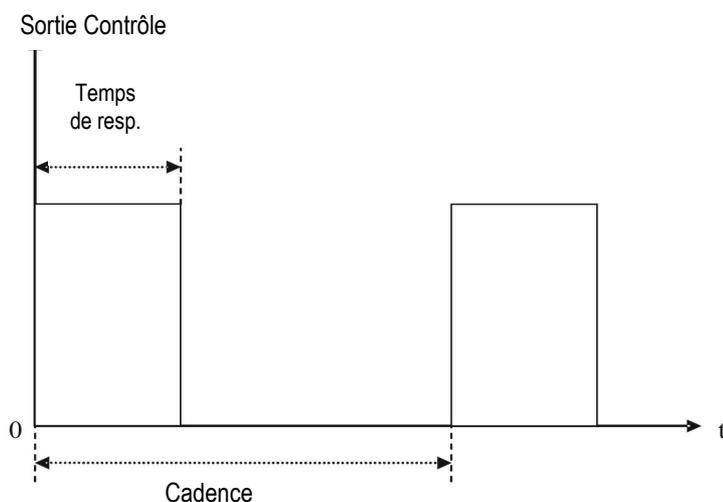
Temps de réponse = Durée totale de fonctionnement / Niveaux de résolution
