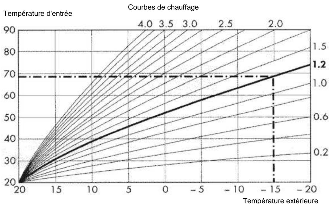
Le graphique montre le type de caractéristique « CC 1.2 ». Ceci signifie que, dans le cas d'une température d'intérieur souhaitée de 20°C et d'une température extérieure de -15°C, la température d'entrée doit être de 70°C.
