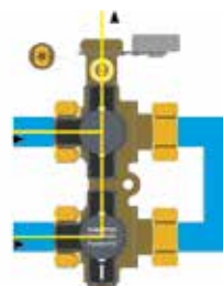
Vullen en ontluichten van de installatie
