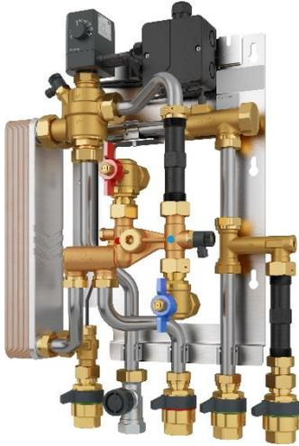
Für die Versorgung einzelner Wohnungen mit Heizungswasser, sowie mit warmem und kaltem Trinkwasser. Die benötigte Heizwärme wird durch eine zentrale Wärmeversorgung bereitgestellt. Die Bereitung des warmen Trinkwassers erfolgt dezentral über einen Plattenwärmeübertrager nach dem Durchlaufprinzip. Bei der Auswahl der Wohnungsstation ist es notwendig die Wasserqualität des Einsatzgebietes zu beachten.
