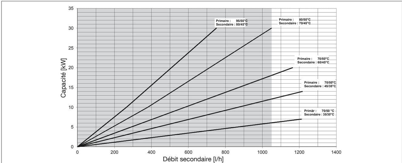
Fig. 7: Diagramme des puissances ; débit max. recommandé Regudis H en combinaison avec Regumat S
