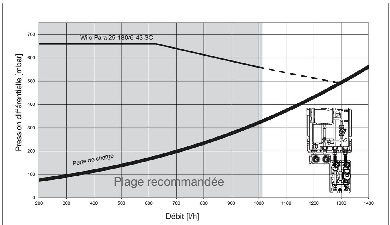
Fig. 5: Perte de charge circuit secondaire Regudis H-M
