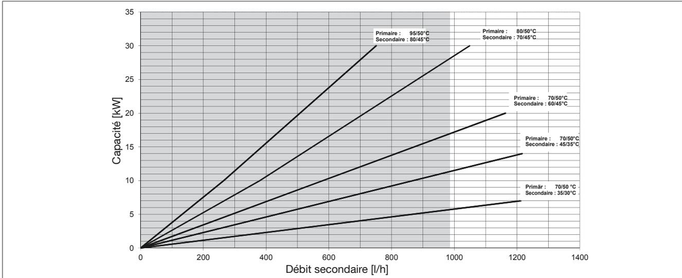
Fig. 6: Diagramme des puissances ; débit max. recommandé Regudis H en combinaison avec le module de commutation HT
