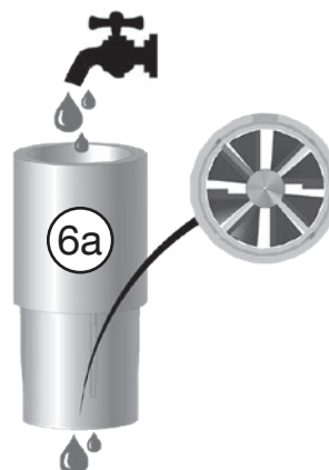
Fig. 5.18: Nettoyer la turbine de mesure sous l'eau courante
