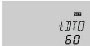
Le paramètre **tDTO** permet de définir la durée pendant laquelle la condition permettant d'activer la pompe devra être réunie pour que celle-ci se mette en route.
