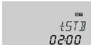
Le paramètre **tSTB** permet de définir la durée pendant laquelle la condition permettant de désactiver la pompe ne sera plus prise en considération à la fin du remplissage du système.
