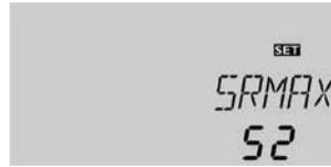
Sélectionnez la sonde que vous souhaitez utiliser pour réaliser cette fonction. Seule la température mesurée par la sonde choisie sera prise en compte pour désactiver le chauffage du réservoir. Si vous choisissez S3, la fonction différentielle sera tout de même réalisée en fonction de la température mesurée par les sondes S1 et S2.
