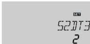
La fonction « Echange de chaleur » utilise la sonde S3 (TSR) comme sonde de référence du réservoir 1 (source chaude) et la sonde S4 ou S5 (S2DT3) comme sonde de référence du réservoir 2 (source froide). Cette dernière est prise en considération pour la fonction différentielle et pour le contrôle du seuil maximal.
