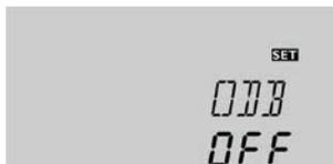
L'option drainback **ODB** sert à renvoyer le caloporteur au réservoir de stockage lorsqu'il n'y a pas assez de chaleur pour chauffer le réservoir en raison du faible rayonnement solaire. Elle permet de régler les paramètres : **tDTO**, **tREM** et **tSTB**.
