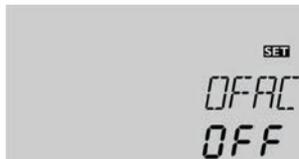
Cette fonction tient compte de la position défavorable des sondes, par exemple dans le cas de sondes placées sur un capteur à tubes sous vide.
