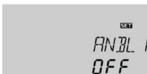
Afin d'éviter tout blocage des pompes en cas d'arrêt prolongé du système, le régulateur est doté d'une fonction antiblocage on/off. Celle-ci active successivement tous les relais, tous les jours à 12:00 et règle la vitesse des appareils électriques reliés à ceux-ci à 100 % pendant 10 secondes.
