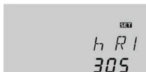
Le compteur d'heures de fonctionnement additionne les heures de fonctionnement d'un relais (**h R1 / h R2/ h R3 / h R4**). L'écran affiche uniquement les heures, pas les minutes.
