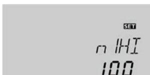
Le canal de réglage **n1(2,3)HI** permet de définir la vitesse maximale relative de la pompe connectée aux sorties R1, R2 et R3.
