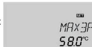
Lorsque la température du réservoir dépasse la valeur **MAX30** préalablement définie, le relais se désactive. Lorsque la température du réservoir est, au contraire, inférieure à ladite valeur, le relais est mis sous tension.
