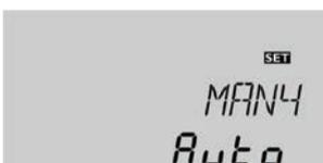
Si vous souhaitez activer ou désactiver les relais manuellement pour effectuer des opérations de contrôle ou de maintenance, sélectionnez le paramètre **MAN**. Vous pourrez alors effectuer manuellement les réglages suivants :
