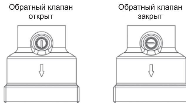
Рис. 3: Положения обратного клапана „Regumat“
