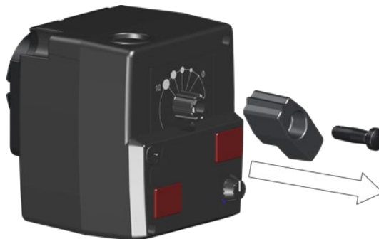
Fig. 31: Demontarea clapetei rotative
