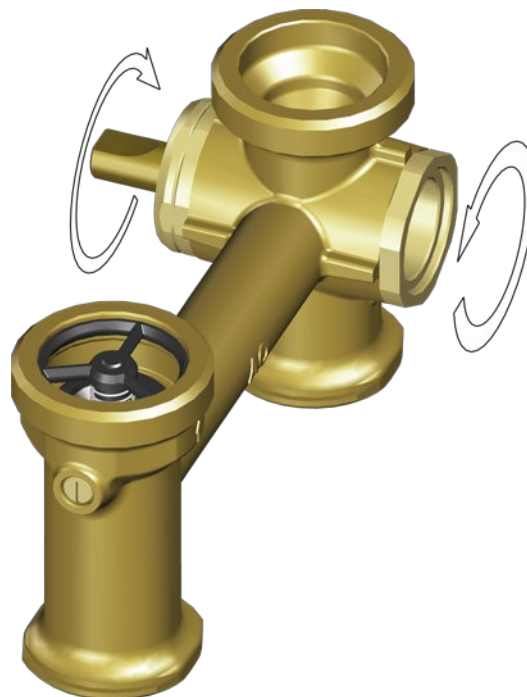
Fig. 35: Desfacerea îmbinărilor filetate ale ventilului de amestec
