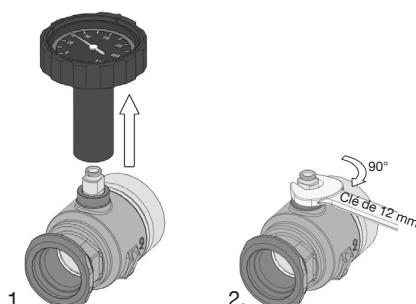
Fig. 21: Fermeture des robinets d'isolation à tournant sphérique
