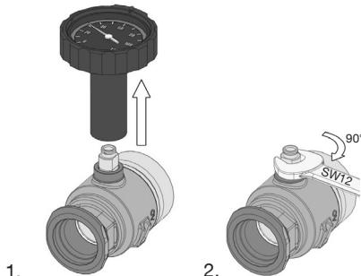
Abb. 21: Pumpenkugelhahn absperren
