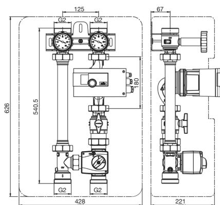
Fig. 2 : « Regumat M3-180 plus » DN 32 avec robinet d'isolement à tournant sphérique
