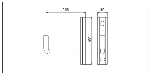
Dimensioni supporto di fissaggio a muro
