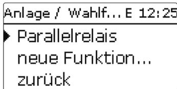
Wenn Funktionen ausgewählt und eingestellt wurden, erscheinen sie im Menü **Wahlfunktionen** über dem Menüpunkt **neue Funktion...**. So ist ein schneller Überblick über bereits aktivierte Funktionen gewährleistet. Ein Überblick, welcher Sensor welcher Komponente und welches Relais welcher Funktion zugewiesen wurde, befindet sich im Menü **Status/Mess-/Bilanzwerte**.
