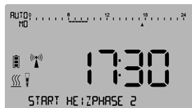
Abb. 34: Display-Anzeige Startpunkt HEIZPHASE 2
