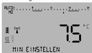
Abb. 41: Display-Anzeige Einstellung unteres Temperatur-Limit
