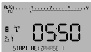
Abb. 30: Display-Anzeige Startpunkt HEIZPHASE 1
