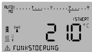
Abb. 50: Display-Anzeige Störungsmeldung (Textzeile)
