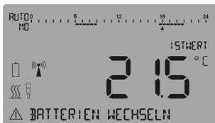
Abb. 51: Display-Anzeige BATTERIEN WECHSELN
