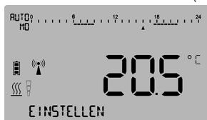
Abb. 40: Display-Anzeige Einstellung neue KOMFORTTEMPERATUR
