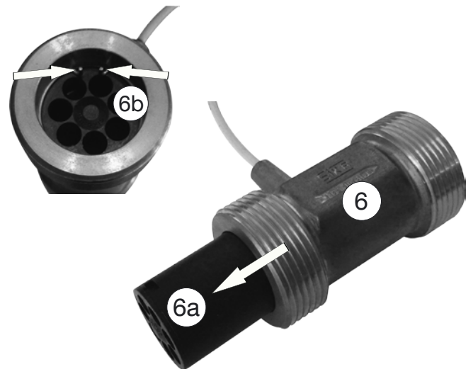
Abb. 5.16: Überwurfmutter Volumenstromsensor lösen
