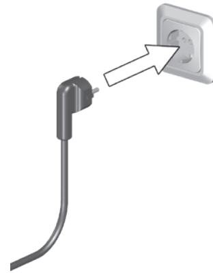
Abb. 4.14: Spannungsversorgung über 230V-Netz
