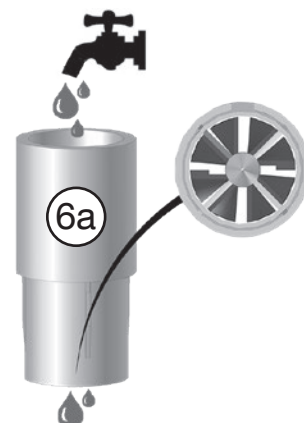
Abb. 5.18: Messturbine unter fließendem Wasser reinigen
