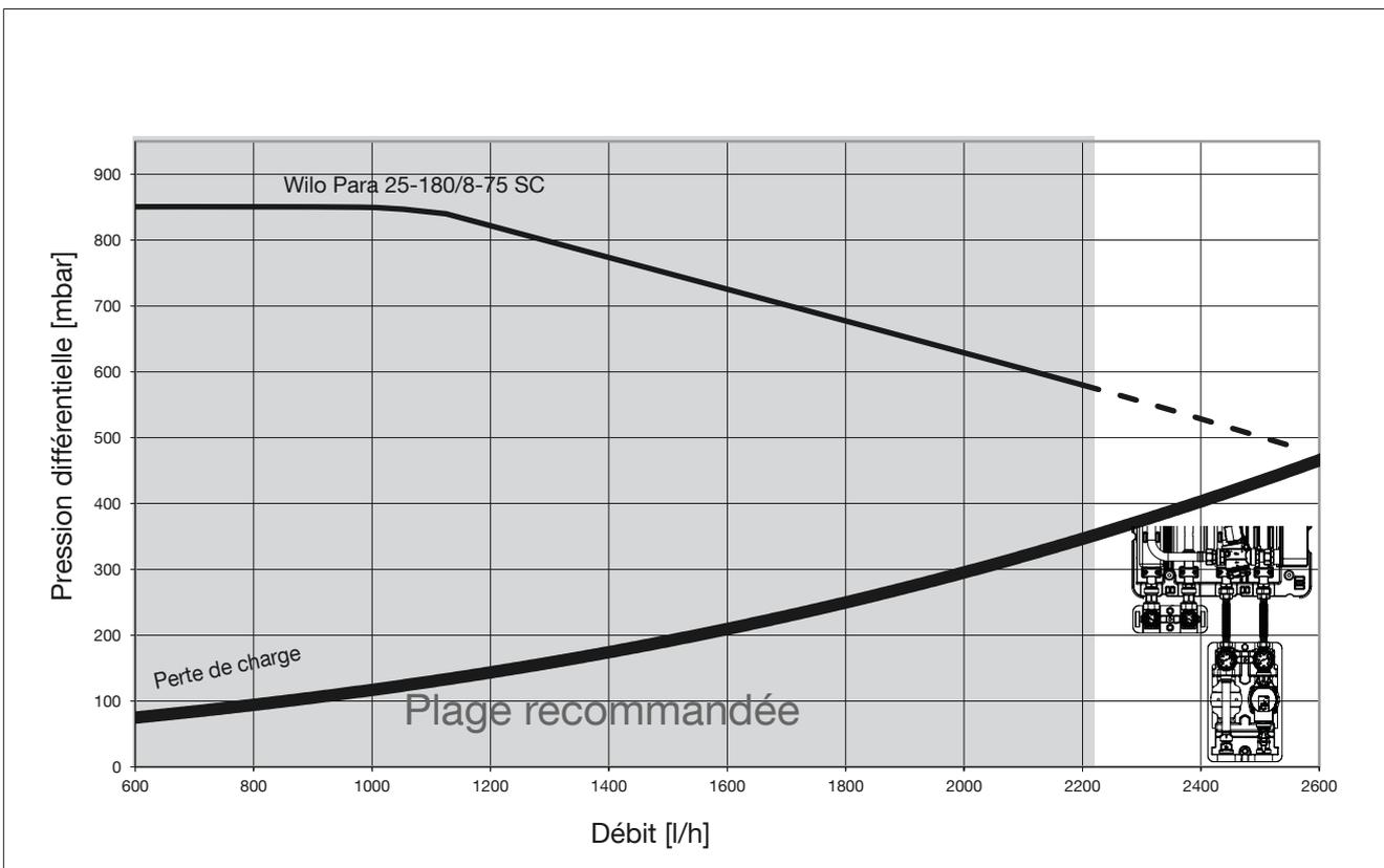
Fig. 5: Perte de charge circuit secondaire Regudis H-H
