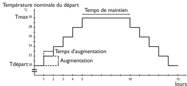
Le diagramme indique les paramètres du séchage de chape avec les réglages d'usine.
