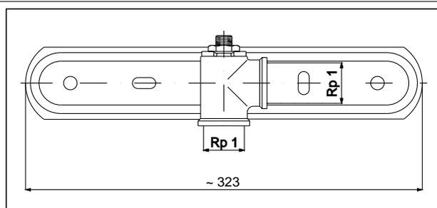
Plaque de fixation pour compteurs à gaz monotubes
