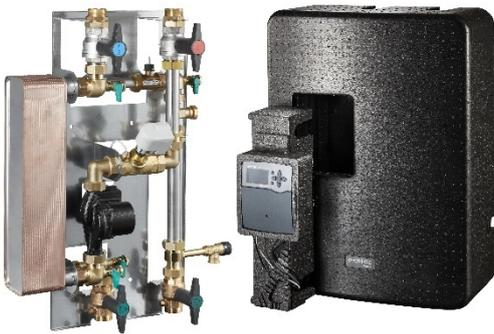
La estación de agua potable Regumaq X-70 es un producto controlado electrónicamente con un intercambiador de calor para el calentamiento higiénico del agua potable según el principio de caudal constante para conectar a un acumulador. Dependiendo de la temperatura y del caudal del lado del agua potable, se controla la velocidad de la bomba de circulación del lado de calefacción. Al seleccionar la estación de agua potable, es necesario considerar la calidad del agua de la zona de uso.
