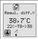
Affichage de la température de la sonde du puits d'énergie dans le menu "Info" avec les valeurs minimales et maximales enregistrées. Par ailleurs est indiqué le lieu de la mesure de température : lci T8.
