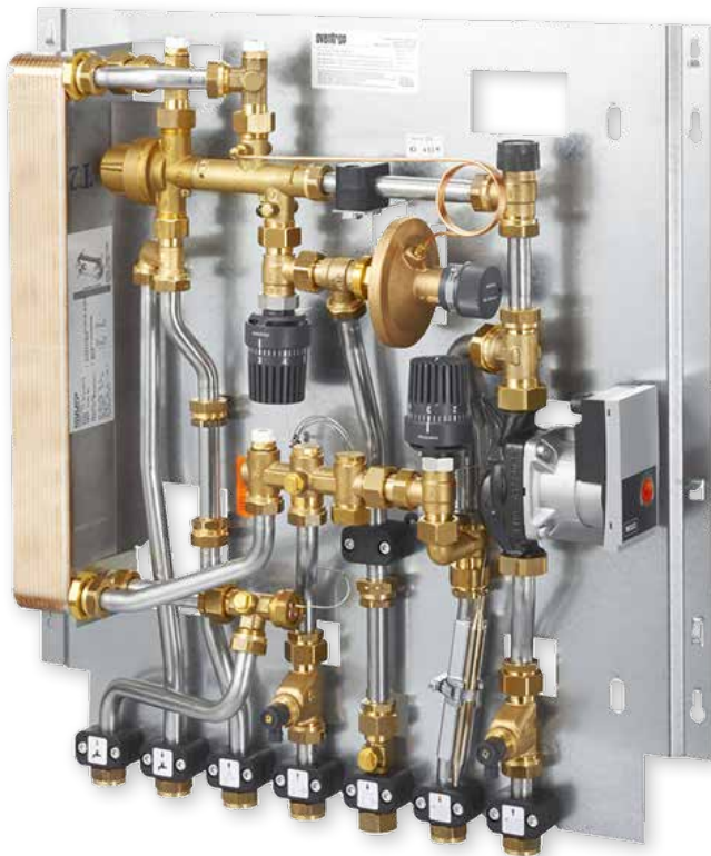
Regudis W-HTF met gemengde verwarmingsgroep, regeling met vaste instelwaarde. Kan worden uitgebreid met weerafhankelijke aanvoertemperatuur regeling. r.
