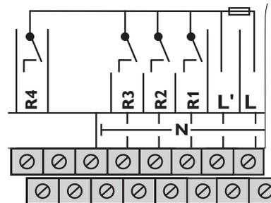
L'alimentation électrique du régulateur s'effectue à travers un câble secteur. La tension d'alimentation doit être comprise entre 100 ... 240V~ (50 et 60 Hz).
