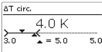
La valeur de réglage  $\Delta T$  circ sert à compenser les pertes de températures dans la ligne de circulation.
