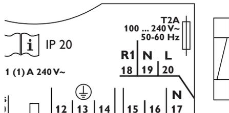
Bornes pour conducteurs de protection, bornes pour appareils électriques, bornes réseau
