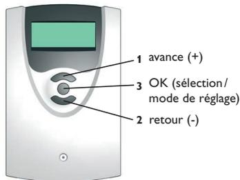
Le régulateur se manie avec les 3 touches de réglage situées sous l'écran d'affichage. La **touche 1 (+)** sert à avancer dans le menu d'affichage ou à augmenter des valeurs de réglage. La **touche 2 (-)** sert à reculer dans le menu d'affichage ou à diminuer des valeurs de réglage. La **touche 3 (OK)** sert à sélectionner des canaux ou à confirmer des réglages.
