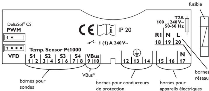
La tension d'alimentation doit être comprise entre 100 ... 40V~ (50 ... 60Hz). Fixez les câbles sur le boîtier à l'aide des serre-fils inclus dans le matériel de montage et des vis correspondantes.
