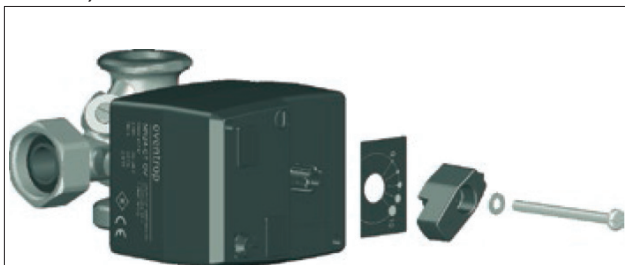
Рис. 5: Смонтировать поворотную рукоятку
