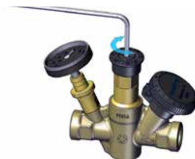
Рис. 8: Установка заданного значения температуры
