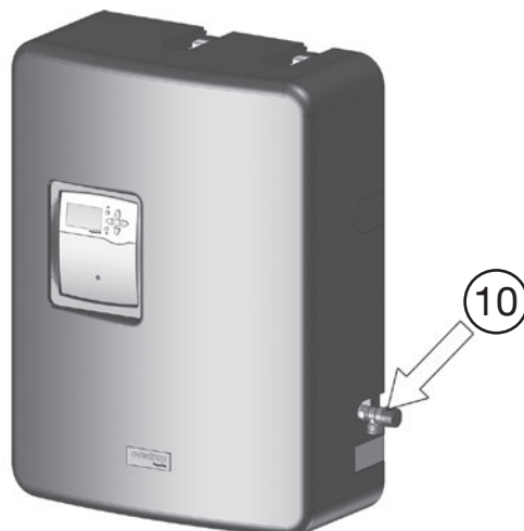
Fig. 6.3: Position de la soupape de sécurité eau potable dans la station
