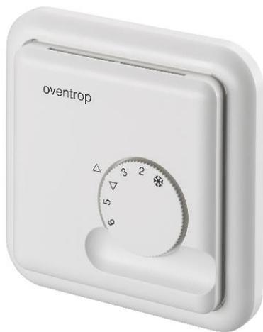
Le thermostat d'ambiance est utilisé pour la régulation de la température dans des installations de surfaces chauffantes et rafraîchissantes ainsi que de plafonds chauffants et rafraîchissants dans les maisons individuelles ou les appartements. La température ambiante est réglée par un robinet, qui est commandé par le thermostat d'ambiance via un moteur électrothermique. Lorsque la température ambiante atteint la température de consigne, le robinet se ferme.
