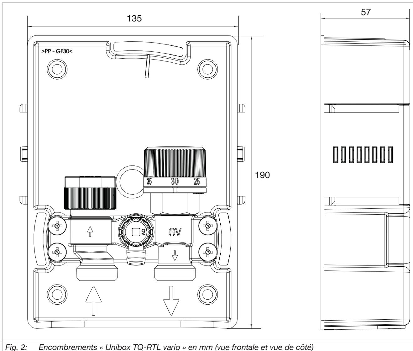
Fig. 2: Encombremments « Unibox TQ-RTL vario » en mm (vue frontale et vue de côté)
