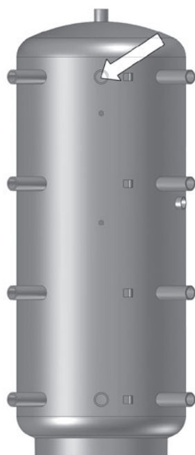
Fig. 4.7: Position de raccordement de la conduite d'alimentation «circuit de ballon d'eau chaude aller» de la station de production d'eau chaude sanitaire au ballon tampon
