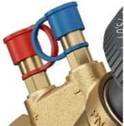
Chaque HydroCom V est équipé de deux robinets auxiliaires HydroPort. Avec l'HydroPort, les accessoires peuvent être raccordés facilement et en toute sécurité avec un verrou à déclic. Les robinets HydroPort s'ouvrent par une courte rotation. Un quart de tour suffit pour mesurer la pression, un tour complet suffit pour vidanger et remplir.
