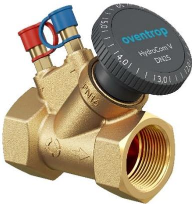
Le robinet d'équilibrage avec orifice de mesure variable HydroCom V sert à l'équilibrage hydraulique des colonnes et des échangeurs de chaleur dans les installations de chauffage et de rafraîchissement à circuits fermés.
