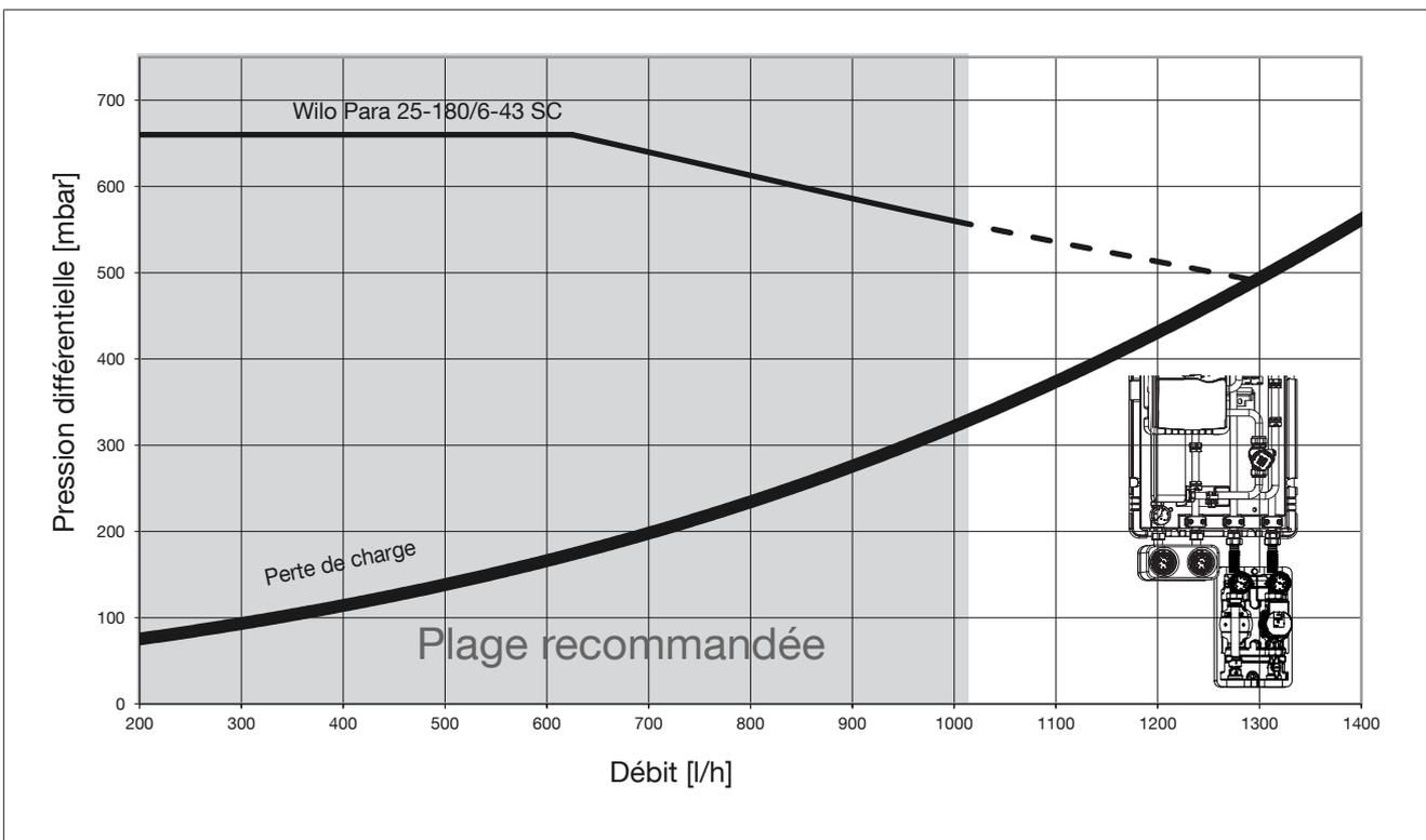
Fig. 5: Perte de charge circuit secondaire Regudis H-H
