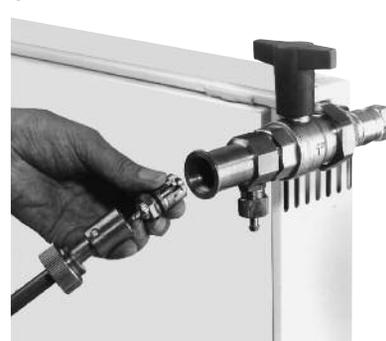
Svitare il cappuccio di chiusura interno del „Demo-Bloc“ ed estrarre il vitone da sostituire o pulire.
