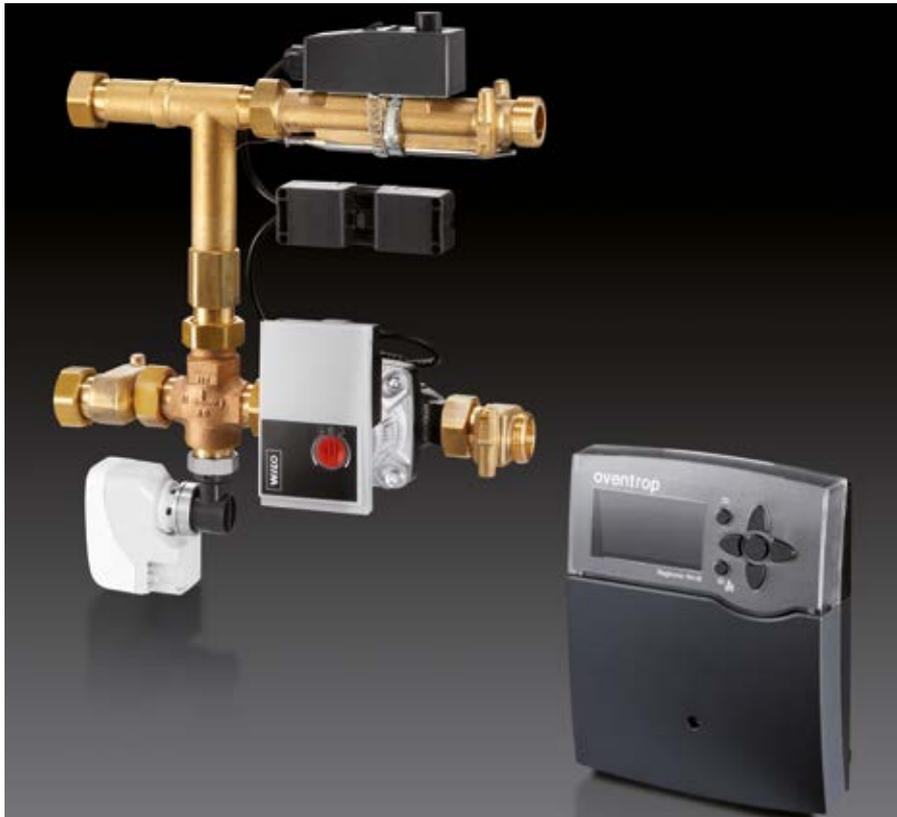
**1** Il gruppo di regolazione “Regufloor HW” viene installato negli impianti di riscaldamento centralizzati per regolare la temperatura di mandata dei sistemi radianti. La regolazione della temperatura di mandata avviene in base alle condizioni climatiche esterne fino a raggiungere un valore massimo impostabile. In tal modo si può rispettare la max. temperatura di mandata consentita per i sistemi radianti (p.es. 45°).
