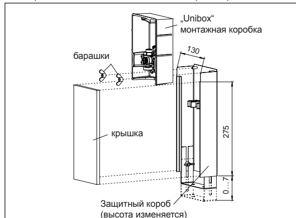
Размеры защитного короба арт. № 102 26 52
