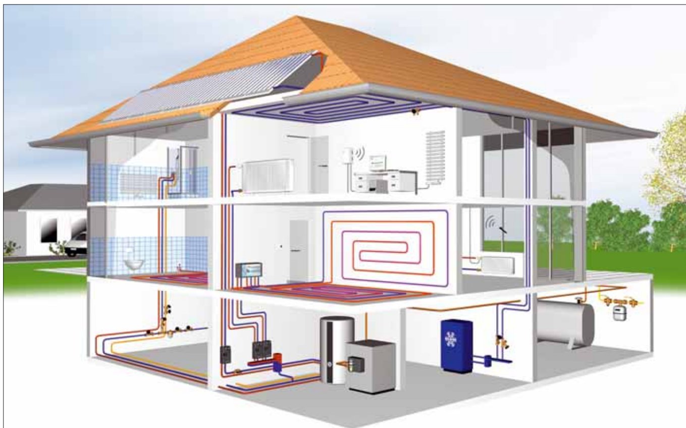
Příklad: Výstavba solární soustavy v rodinném domku
