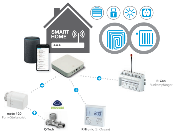
Fig. 1: Préréglage et équilibrage automatiques avec la centrale de communication wibutler pro et la technique Q-Tech
