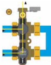
Umplerea și aerisirea instalației
