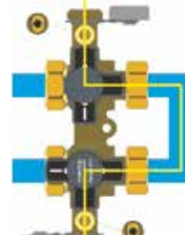
Reumplerea, aerisirea și spălarea consumatorului cu ajutorul unui al doilea robinet sferic de umplere și golire
