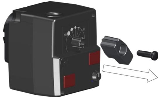
Abb. 31: Drehgriff demontieren
