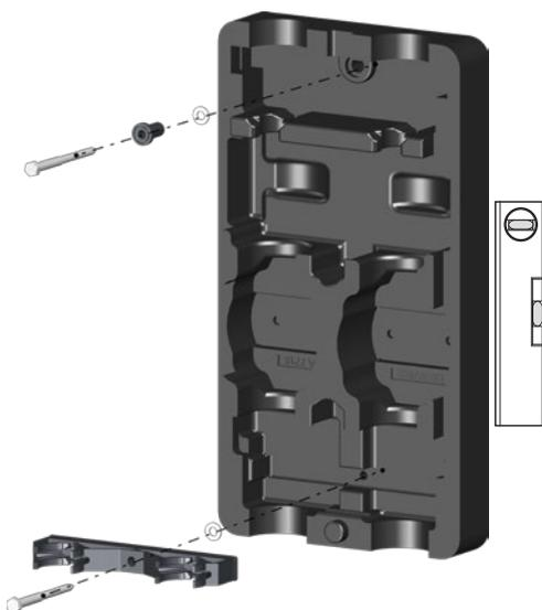
Abb. 23: Unterschale anschrauben
