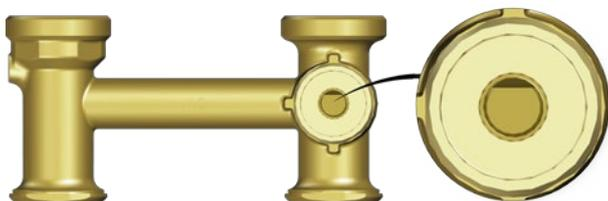
Abb. 37: Mischerküken ausrichten
