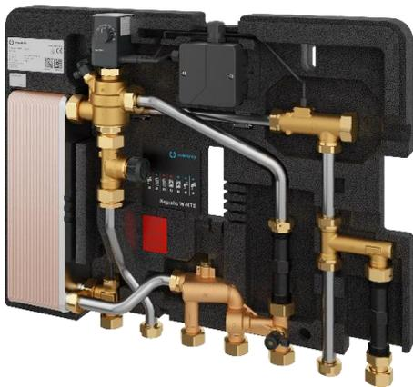
Pour l'approvisionnement d'appartements individuels en eau de chauffage, eau chaude sanitaire et eau froide. La chaleur de chauffage nécessaire est fournie par une distribution de chaleur centrale. L'eau potable est chauffée de manière décentralisée via un échangeur de chaleur à plaques en circulation continue. La qualité d'eau dans la région d'utilisation doit être prise en compte lors du choix de la station d'appartement.
