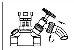
3. Schlauchleitung anschließen.
