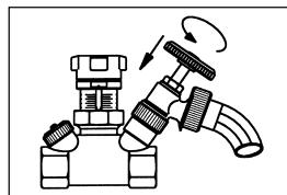
4. Das Handrad nach unten drücken und dabei linksdrehen. Hinweis: Zunächst rastet die Spindel ein, dann öffnet das Ventil zum Entleeren oder Befüllen.
