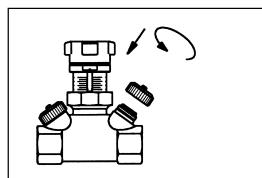
6. Nach Beendigung des Vorganges die Schlauchleitung und das Füll- und Entleerungswerkzeug abschrauben und die Schutzkappe wieder aufschrauben.
