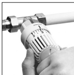
Fig. 7: Apăsați puternic sau loviți mânerul cu podul palmei până când acesta se fixează în locașul lui. Intervalul de setare al termostatlui este acum limitat. Acum se pot seta numai valori cuprinse între cifra „2” și cifra „4” (cca. 16 °C - 24 °C).
