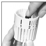
Fig. 4: Pentru limitarea intervalului de setare în partea inferioară, de exemplu la cifra „2” (corespunde unei temperaturi de cca. 16 °C), se inserează clipul în fanta de dinaintea cifrei „2”, așa cum se vede în imagine. (Fanta aflată chiar în dreptul cifrei „2” rămâne așadar liberă).
